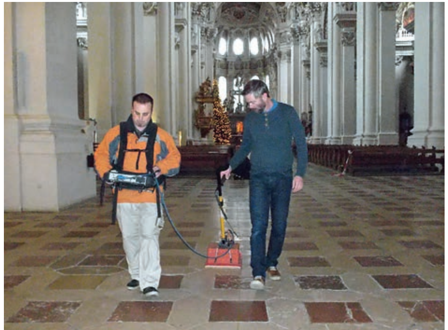
Passau, Dom St. Stephan. Messung mit dem Gerät GSSI SIR-4000. Um auch kleinere Bereiche erfassen zu können, wurde die Antenne auf einen Schlitten montiert (Foto: BLfD, Josef Lichtenauer)
