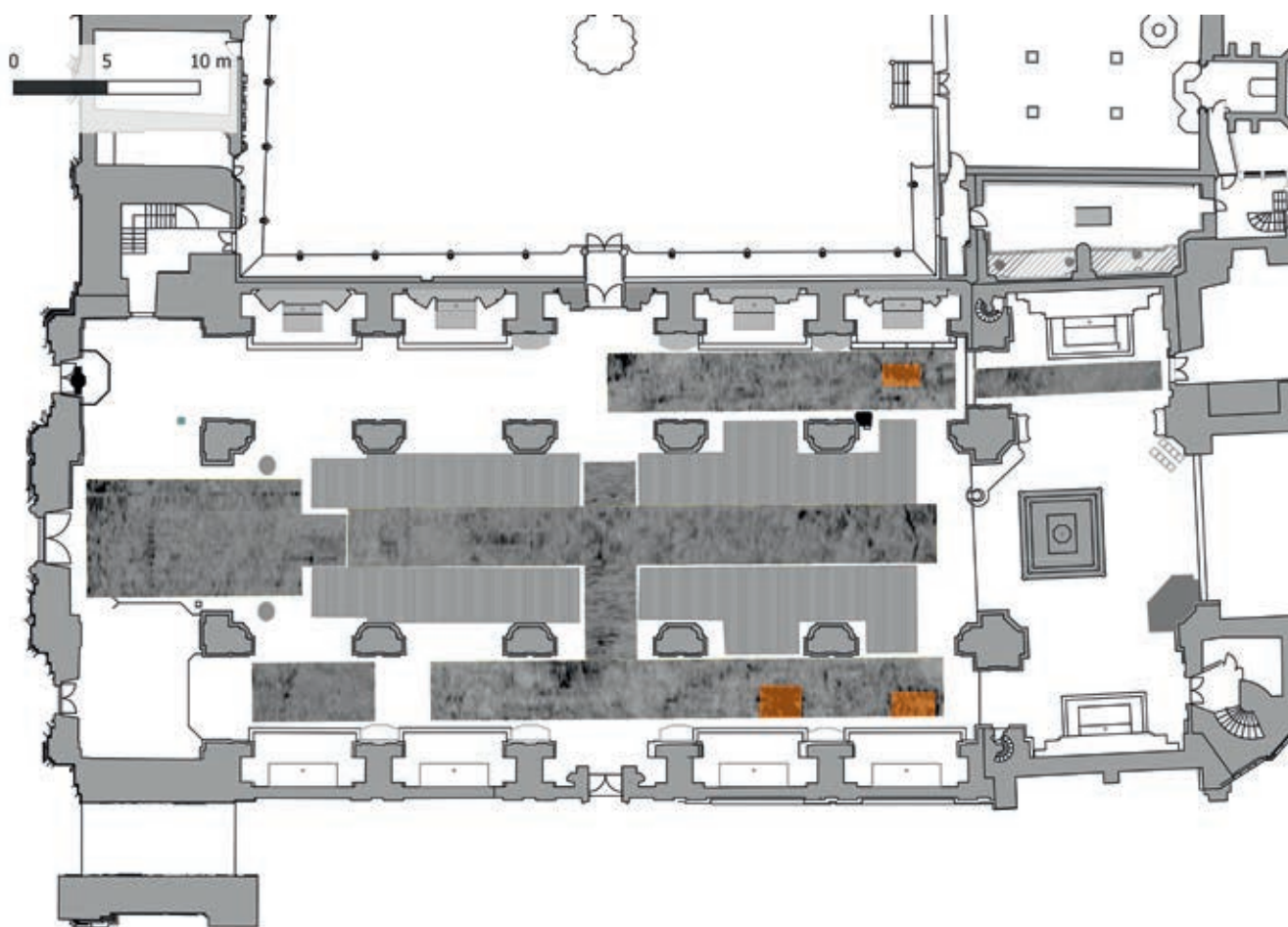
Passau, Dom St. Stephan. Bodenradar-Tiefenscheibe im Bereich 60–80 cm unter der Oberfläche mit Markierung der Lage und Ausdehnung der drei Bischofsgräber (orange), GSSI SIR-4000 mit 400-MHz-Antenne, Messpunktabstand: 6 × 25 cm, Archiv-Nr. 7546/006 (Radargramm / Interpretation: Roland Linck, Grundrissplan Dombauhütte Passau 2019)
