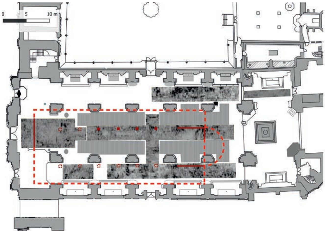
Passau, Dom St. Stephan. Bodenradar-Tiefenscheibe im Bereich 100–120 cm unter der Oberfläche. Überlagert mit der Interpretation der archäologischen Befunde des karolingischen Doms (rot: eindeutig nachgewiesene Befunde, rot gestrichelt: rekonstruierter Grundriss der Basilika), GSSI SIR-4000 mit 400 MHz-Antenne, Messpunktabstand: 6 × 25 cm, Archiv-Nr. 7546/006 (Radargramm / Interpretation: Roland Linck, Grundrissplan: Dombauhütte Passau 2019)
